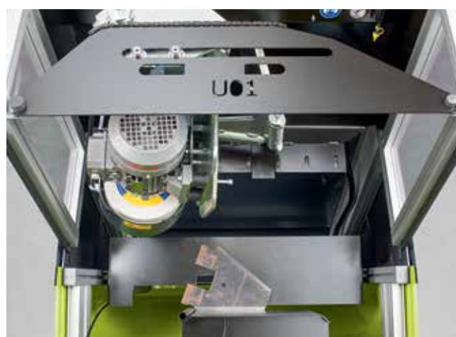
Affûtage de couteaux à lame droite selon le profil de lame d'origine.
