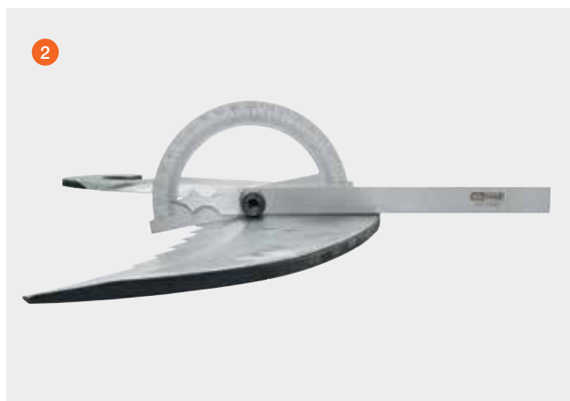
Couteaux affûtés à l'aide de l'AQUA NON STOP COMFORT à un angle adéquat ( 10^\circ ).
